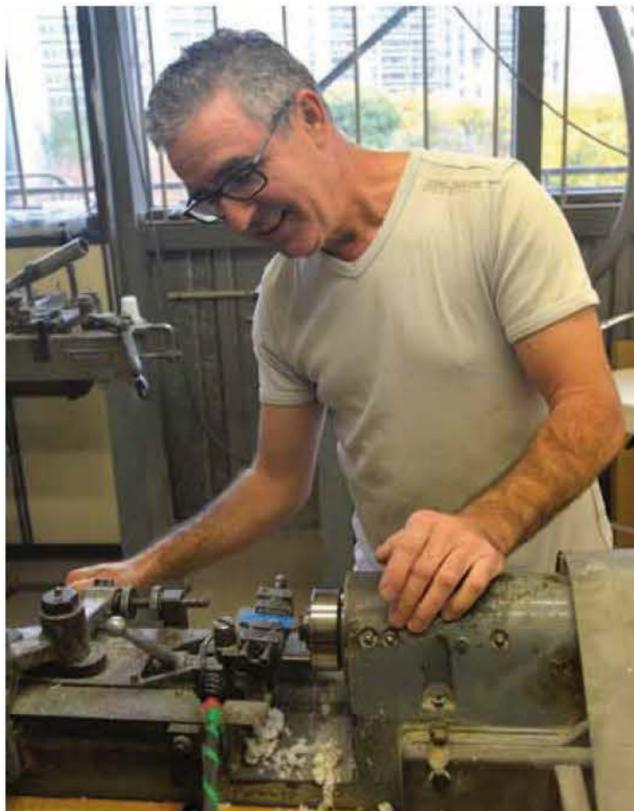
En production mécanique, l'outil (pièce bleue), permettant le façonnage de chaque pion, est fabriqué à la meule.
