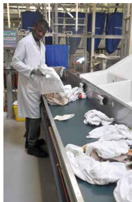
❷ ...puis trié à la main : à travers les alvéoles, le linge rejoint un chariot.
