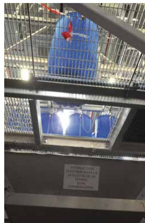
❺ Le contenu des sacs est déversé dans un tunnel d'environ 3 mètres de long et 2 mètres de haut, constitué de plusieurs modules de lavage, un peu comme si des machines à laver avaient été emboîtées, chacune lavant à des températures et avec des produits différents.
