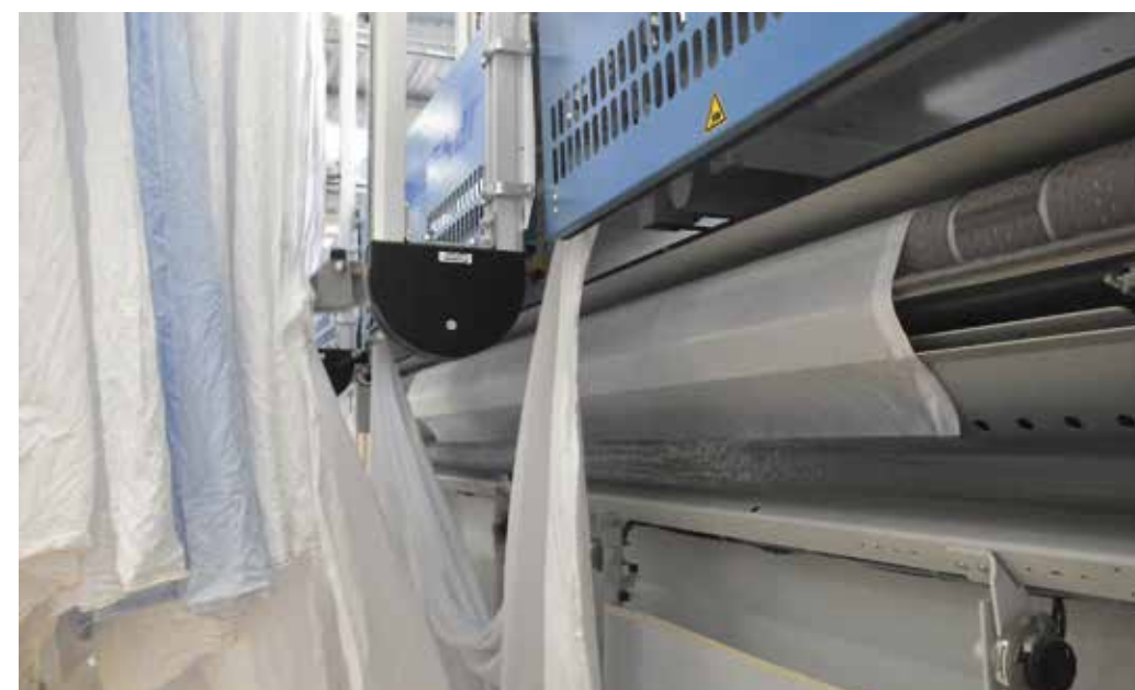
❻ À l'entrée de la machine, les draps sont récupérés par des rouleurs et en ressortent, à l'autre extrémité, en piles repassées.
