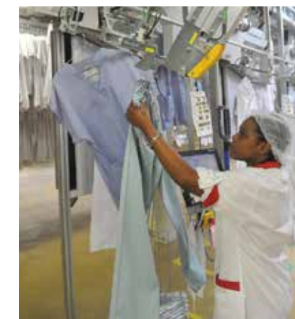
❽ En bout de chaîne, l'état de chaque pièce, identifiée par puce électronique, est vérifié à la main.
