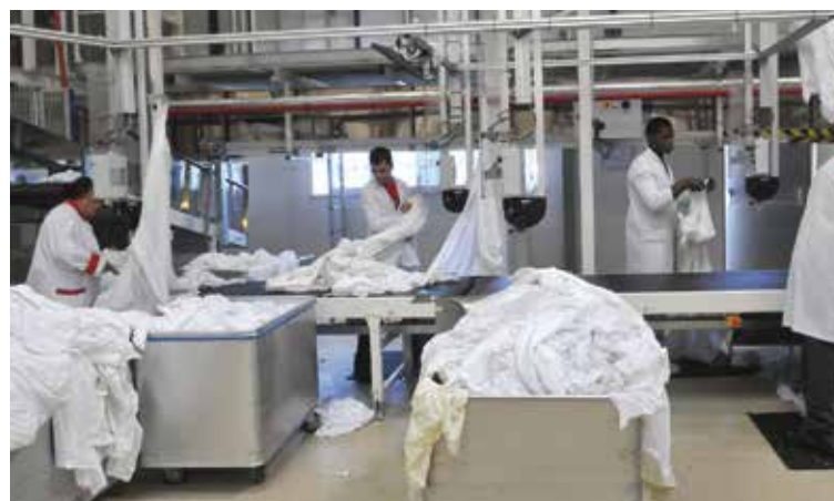
❸ Depuis les chariots, les pièces sont placées dans des sacs bleus dont le contenu est calibré : une fois le poids atteint, le sac suit son chemin aérien sur les rails jusqu'au tunnel de lavage.
