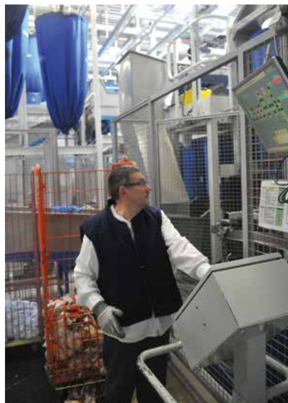
❸ Depuis les chariots, les pièces sont placées dans des sacs bleus dont le contenu est calibré : une fois le poids atteint, le sac suit son chemin aérien sur les rails jusqu'au tunnel de lavage.
